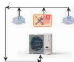
Refrigerante armazenado na unidade exterior
